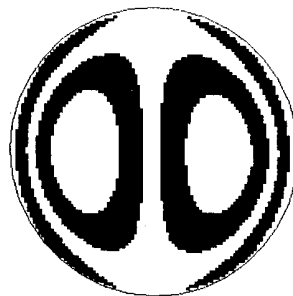
contour interval: 0.05\lambda P-V: 0.117\lambda RMS: 0.028\lambda
