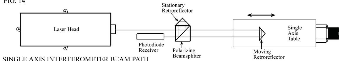
SINGLE AXIS INTERFEROMETER BEAM PATH
