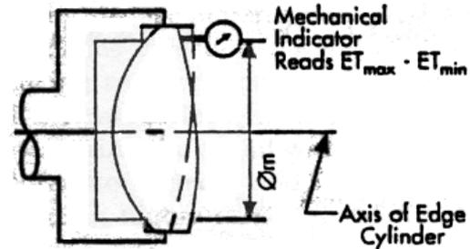
$$\sigma = \frac{ET_{max} - ET_{min}}{\varnothing m} \cdot 0,00029 \text{ min}$$
